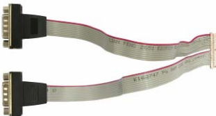
1 x Dual COM Cable (OALES-BKU2-H14NB / 1040379)
