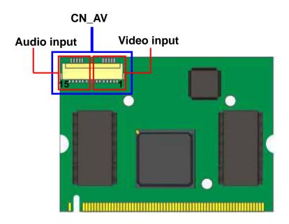
CN\_ AV Type: 15-pin DF14/Male (Pitch=1.25mm)
